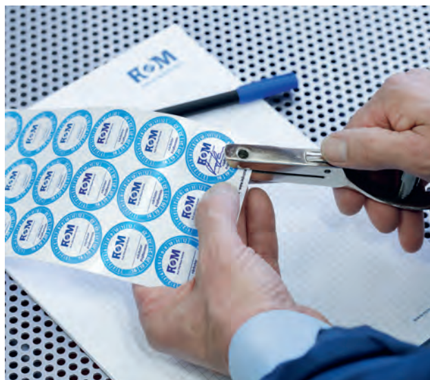
Die Plakette bestätigt die Prüfung und zeigt den nächsten Termin an
