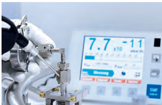
Die Helium-Lecksuche mit Vakuummethode liefert sichere Ergebnisse
