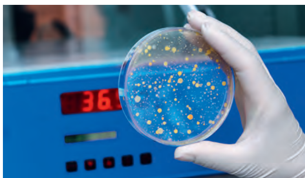
In der Petrischale zeigt sich die Keimbelastung in der Druckluft
